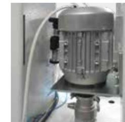
Integrierte Wasserdruckerhöhung (std)
