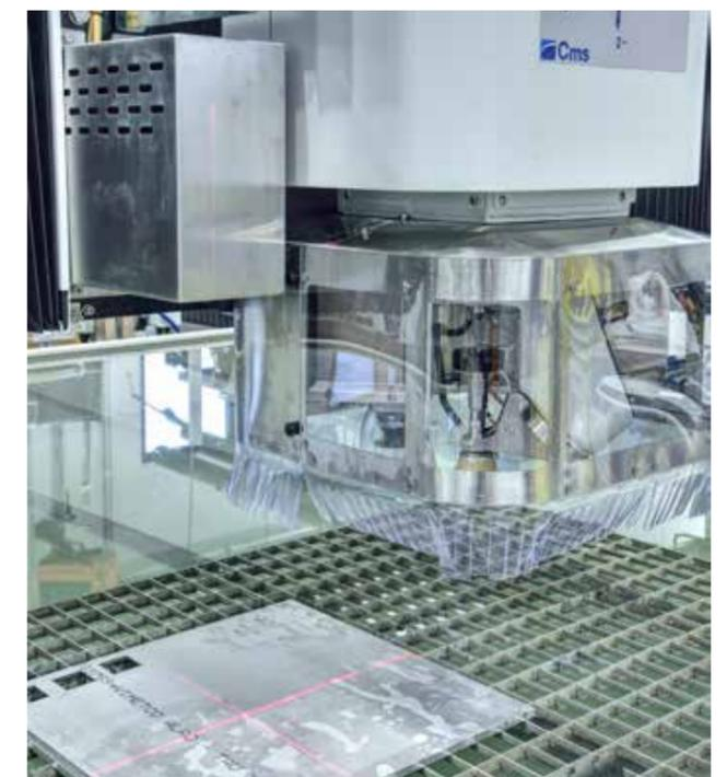
Schneidkopfschutz zum Schutz vor Wasser und Staub während des Schneidprozesses. (Verfügbar für 5-Achsen Schneidkopf EVO)
