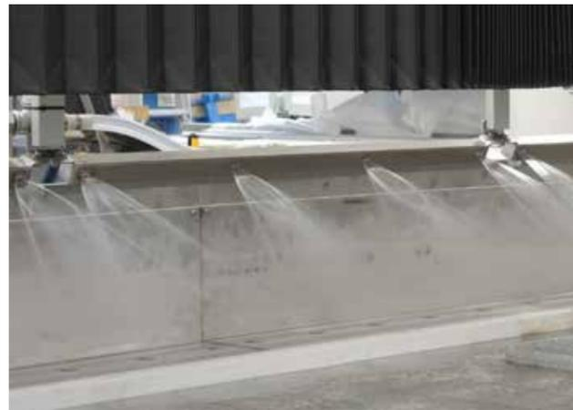
Sprühleiste zur Reinigung der Werkstücke und des Arbeitstisches, ausgestattet mit einer separaten Pumpe, entfernt Abfallstücke und aufgespülten Abrasivsand. Komplette Reinigung des Arbeitstisches vor Be- und Entladung.
