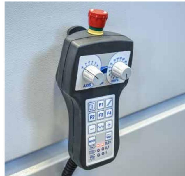
Fernsteuerung von bis zu 6 Achsen über Handflasche, erlaubt das einrichten der Achsen direkt am Schneidbecken, z. B. zum anfahren von Nullpunkten.
