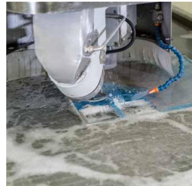
Sprüheinheit am Schneidkopf um Kratzer auf empfindlichen Werkstücken zu vermeiden. Verbesserte Höhenmessung da der Sand von der Oberfläche entfernt wird. (Opt.)
