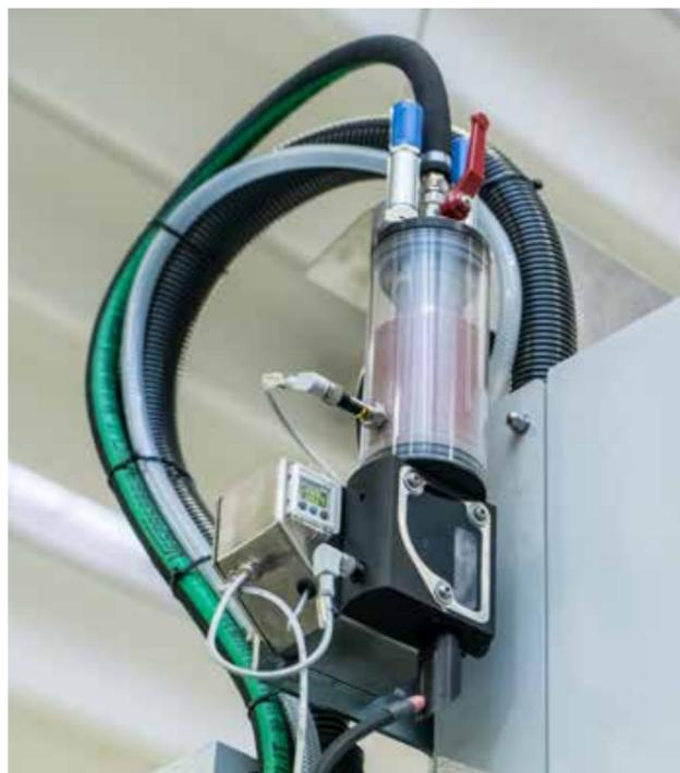
Unter Druck stehender Abrasivbehälter mit 330 kg Fassungsvermögen, ausgestattet mit zwei Tanks: einem mit 330 kg Fassungsvermögen und einem weiteren - mit Druck beaufschlagt - zur Versorgung des Schneidkopfes (Sanddosator). Ebenfalls erhältlich ist ein zweistufiger Big-Bag Abrasivbehälter mit einem Fassungsvermögen von bis zu 2000 kg, damit auch sehr lange Schneidarbeiten ohne Unterbrechung durchführbar sind.
