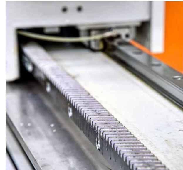
Präzisions-Paket X- und Y-Achse, Verfahrung über Zahnrad und schräg verzahnten Zahnstangen für minimale Toleranzen und höchste Positionsgenauigkeit.
