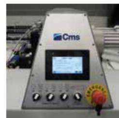
Elektronische Kontrolle des Schneidedrucks mittels Software
