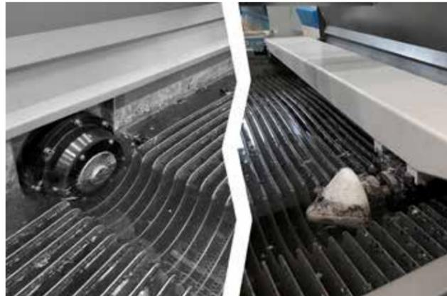
DREHACHSE ZUR ROHRBEARBEITUNG: CNC-gesteuerte Bearbeitung von runden oder eckigen Rohren bis zu einem Außendurchmesser von 800 mm in Verbindung mit einem 5-Achsen Schneidkopf.
