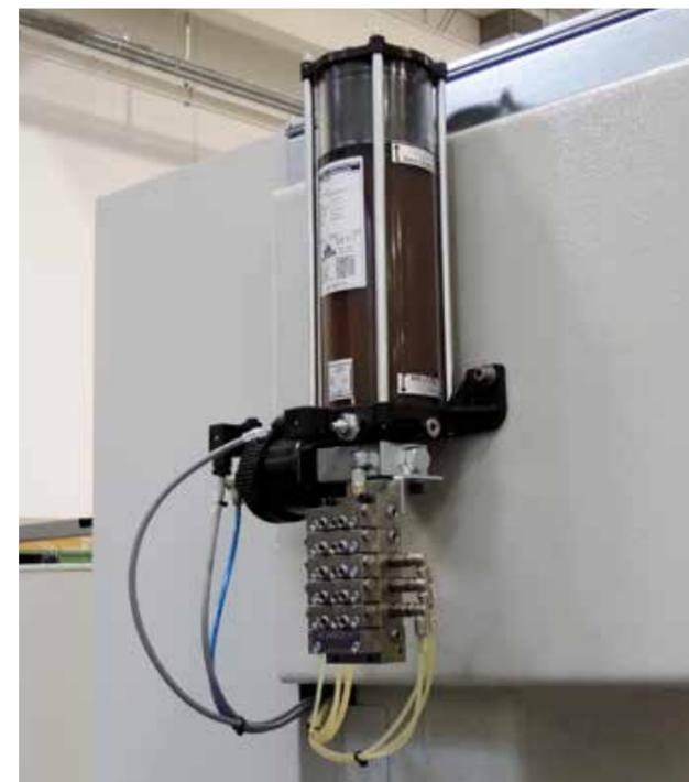
Automatische Zentralschmierung für alle Achsen
