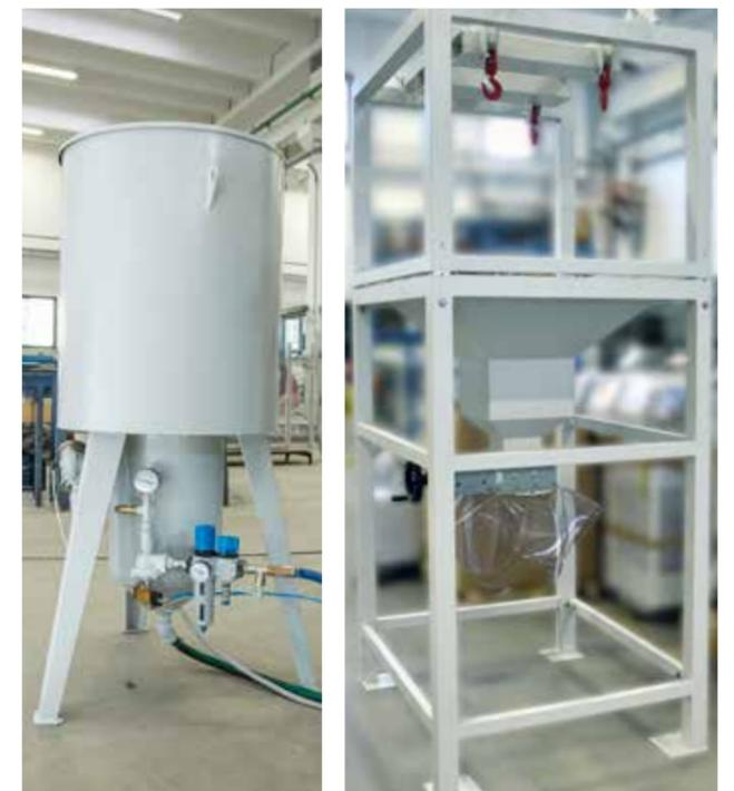
Automatische Wassernivellierung, integrierter Tank an der Rückseite der Maschine zur automatischen Hebung und Senkung des Wasserlevels (max. 45 mm) . Für Geräuschreduziertes Unterwasserschneiden und eine saubere Arbeitsumgebung.
