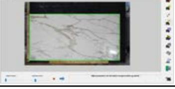
DDXPhoto: Kameraerfassung von Rohplatten mit Import von 1:1-Abbild                                    |       | ○     | ○        | ○       |
