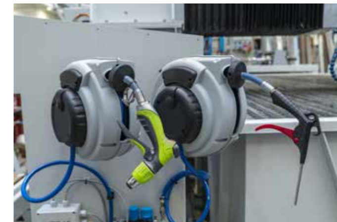
AUTOMATISCHE AUFROLLER FÜR WASSER UND LUFTPISTOLE Zur Reinigung von Material und Arbeitstisch. (opt.)
