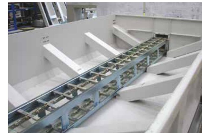
Kettenfördersystem für "Wartungsfreie" Abrasiv-Austragung. Das integrierte Entsorgungssystem wird geschützt durch spezielle Dichtungstechnik und einem "Metall-Käfig". Der Tank ist vorbereitet für die Installation. (opt.)
