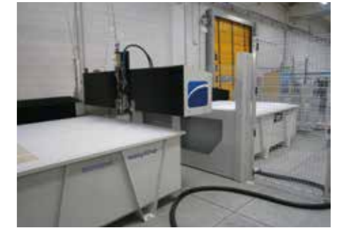
Verfügbar mit einem oder zwei separaten Schneidbecken für pendulares Arbeiten (opt).
