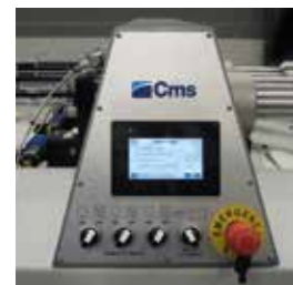
Elektronische Kontrolle des Schneidedrucks mittels Software
