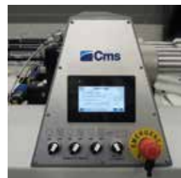
Elektronische Kontrolle des Schneidedrucks mittels Software
